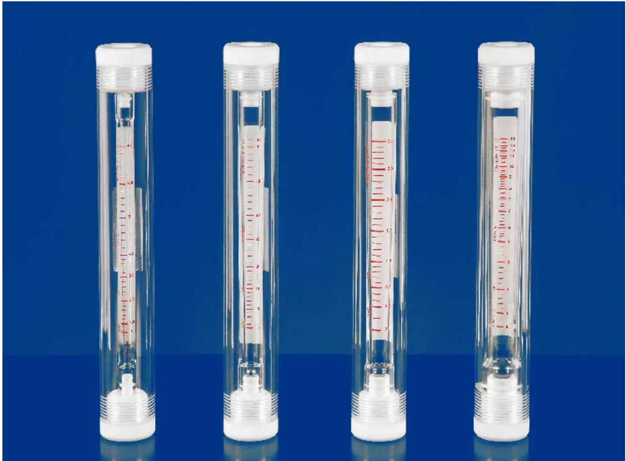
Os rotâmetros da série KPT, são medidores de baixas vazões. É indicado para uso com fluídos de alta corrosividade (ácidos clorados, sulfúrico, SO<sub>2</sub> etc).
