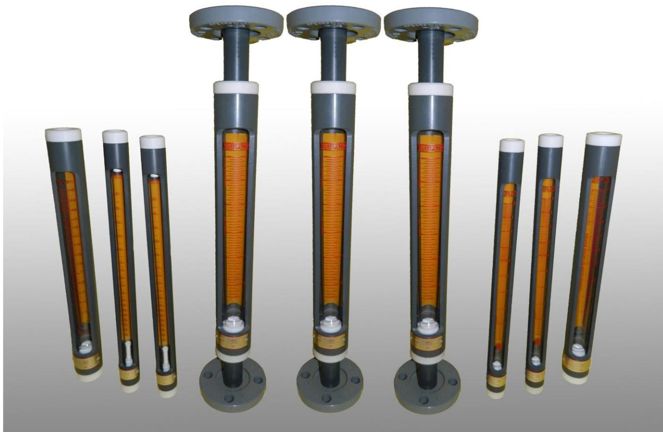
São medidores de vazão instantânea para líquidos ou gases para pequena e média vazão. Construídos totalmente em plástico de engenharia com alta resistência mecânica, resistência química a corrosão por fluídos extremamente corrosivos tais como, ácido clorídrico, ácido fosfórico, SO<sub>2</sub>, cloro, entre outros.
