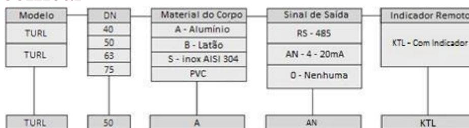
TURBINA CONEXÃO ROSCADA, DIAM. 2" BSP, CORPO EM ALUMÍNIO COM SAÍDA 4 a 20mA E INDICADOR LOCAL.
