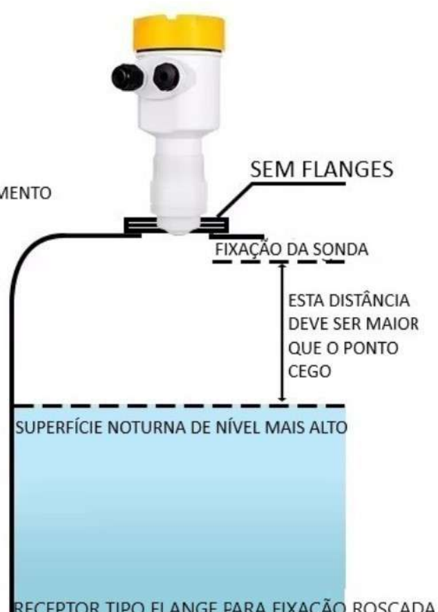
B: QUANDO NÃO É POSSÍVEL A MONTAGEM DA SONDA NO CENTRO DO TANQUE
